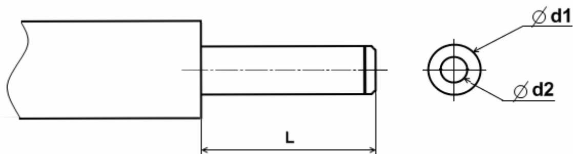
Рис.4 Штекер для дополнительного разъема питания видеомонитора: d1=5,0\dots6,0\text{мм} ; d2=2,0\dots2,5\text{мм} ; L=9\dots13\text{мм} .
